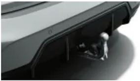
Anhängerkupplung mit schwenkbarem Kugelkopf (S03AC)
