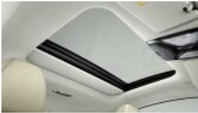
Glasdach, elektrisch mit Schiebe- und Hebefunktion (S0403)
