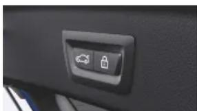
Automatische Heckklappenbetätigung (S0316)
