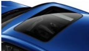
Glasdach, elektrisch mit Schiebe- und Hebefunktion (S0403)
