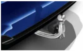
Anhängerkupplung mit schwenkbarem Kugelkopf (S03AC)
