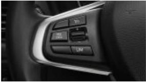
Geschwindigkeitsregelung mit Bremsfunktion (S0544)
