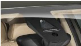
Regensensor und automatische Fahrlichtsteuerung (S0521)
