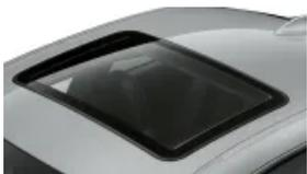
Glasdach, elektrisch mit Schiebe- und Hebefunktion *(S0403)*
