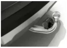
Anhängerkupplung mit schwenkbarem Kugelkopf (S03AC)
