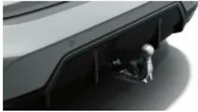
Anhängerkupplung mit schwenkbarem Kugelkopf (S03AC)
