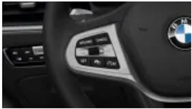
Geschwindigkeitsregelung mit Bremsfunktion (S0544)
