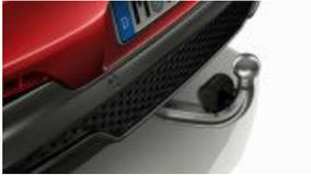
Anhängerkupplung mit schwenkbarem Kugelkopf (S03AC)
