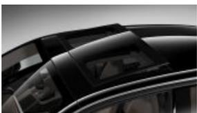
Glasdach, elektrisch mit Schiebe- und Hebefunktion (S0403)
