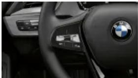
Geschwindigkeitsregelung mit Bremsfunktion *(S0544)*
