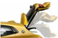
Automatische Heckklappenbetätigung (S0316)
