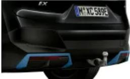
Anhängerkupplung mit schwenkbarem Kugelkopf (S03AC)
