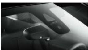
Regensensor und automatische Fahrlichtsteuerung (S0521)
