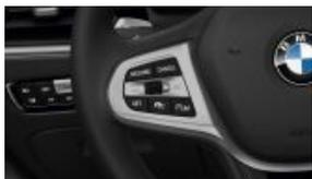
Geschwindigkeitsregelung mit Bremsfunktion (S0544)
