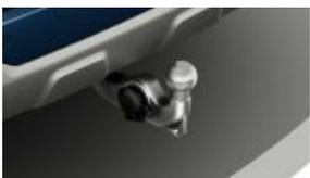
Anhängerkupplung mit schwenkbarem Kugelkopf (S03AC)
