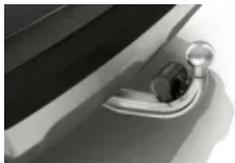
Anhängerkupplung mit schwenkbarem Kugelkopf (S03AC)
