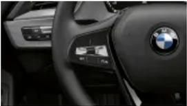
Geschwindigkeitsregelung mit Bremsfunktion (S0544)
