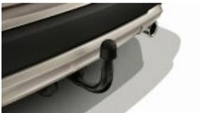
Anhängerkupplung mit abnehmbarem Kugelkopf (S0235)
