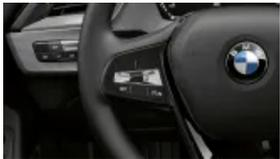
Geschwindigkeitsregelung mit Bremsfunktion *(S0544)*
