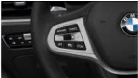
Geschwindigkeitsregelung mit Bremsfunktion *(S0544)*
