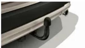
Anhängerkupplung mit abnehmbarem Kugelkopf *(S0235)*
