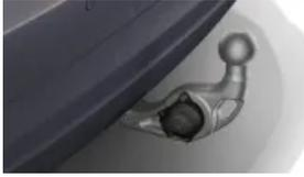
Anhängerkupplung mit schwenkbarem Kugelkopf (S03AC)
