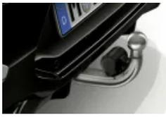
Anhängerkupplung mit schwenkbarem Kugelkopf (S03AC)
