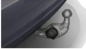
Anhängerkupplung mit schwenkbarem Kugelkopf
